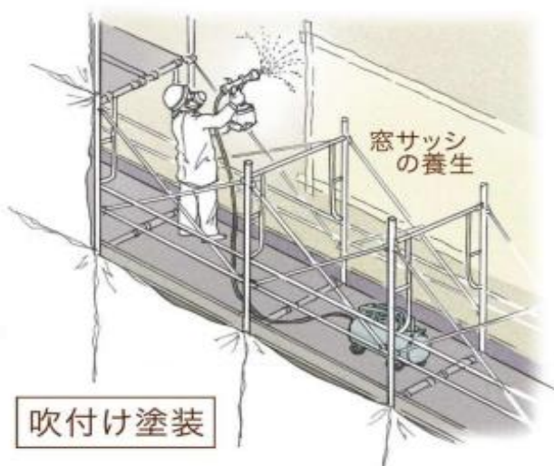
従来の吹付塗装作業 イメージ図
